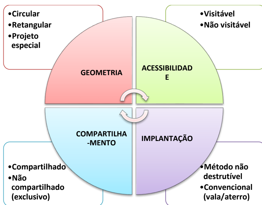
Figura 7 - Infraestrutura existente Classificação das galerias Técnicas
